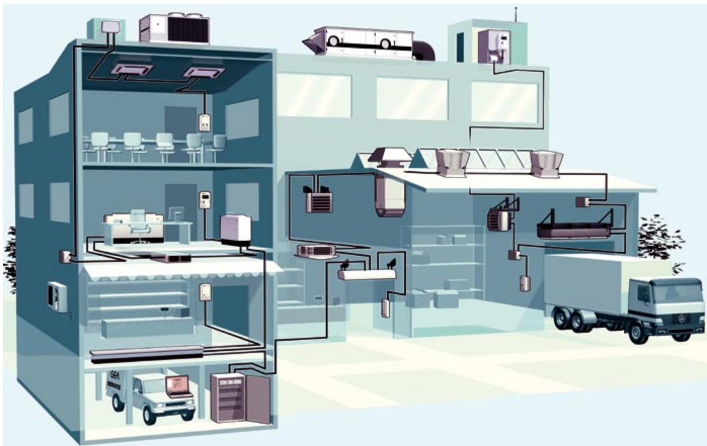
La carte réseau GEA MATRIX.Net fait partie en standard de chaque composant «intelligent». Le câblage uniforme et l'intégration à n'importe quel endroit dans le réseau des outils de paramétrage offrent un gain de temps et de coûts pour la mise en service d'une installation.
